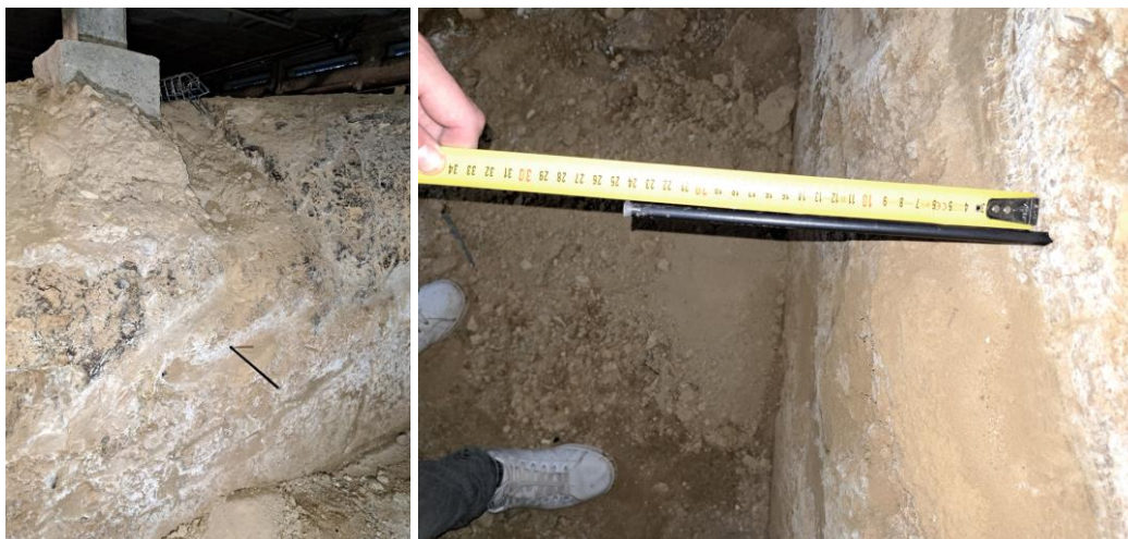
TIGE N°1 (lg :71,5cm) ancrée sur 46,5 cm au niveau +0.88m/TN
